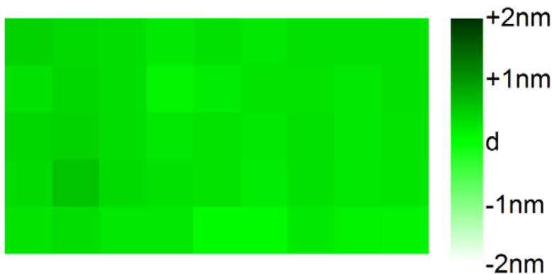
图片说明: 狭缝涂布机使得通过 iXsenic® 前体解决方案生产的薄膜能够拥有卓越的涂层厚度及均匀性 (误差范围小于 0.5 nm)
