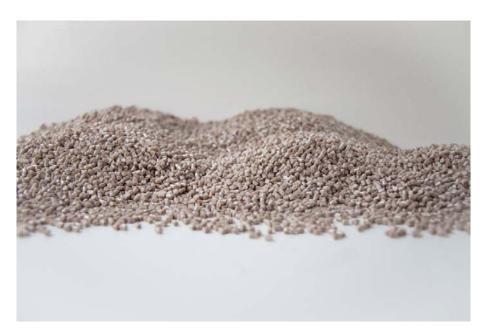
赢创的 VESTAKEEP®品牌的 PEEK 聚合物,具有极佳的耐热和耐化学性。
