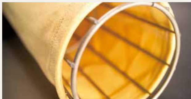
◉ P84°聚酰亚胺纤维制成的过滤袋，可以比圆形纤维滤袋多出80%的比表面积，实现更高的表面过滤效果
